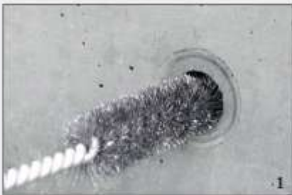
1 Je-li distanční trubka znečištěná, vyčistěte ji
